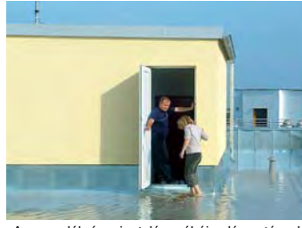
A csapadékvíz szigetelés próbája elárasztással
